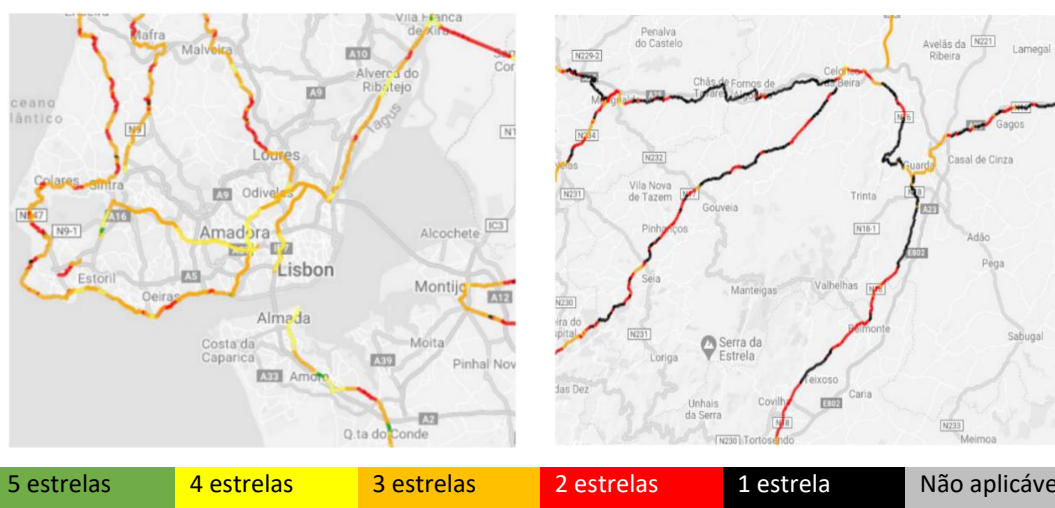
Figura 39 – Resultado da avaliação EuroRAP para estradas na zona de Lisboa (Fonte: ANSR, 2020)
